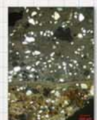
Campione CSB-7A Strati preparatori della Parete Est (microfotografia in sezione sottile, luce trasmessa, N+)
